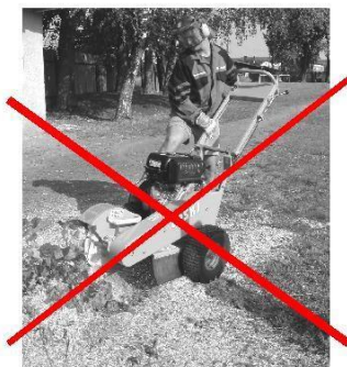
Kõrval seismine – vale asukoht
